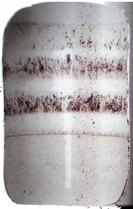
Aceste inele negre sunt bio-mâzgă formată în interiorul unei găleți a unei instalații de ceai de compost. Dacă este lăsată acolo, această mâzgă poate influența decisiv calitatea ceaiului produs. Fotografie de Judith Hoersting.
