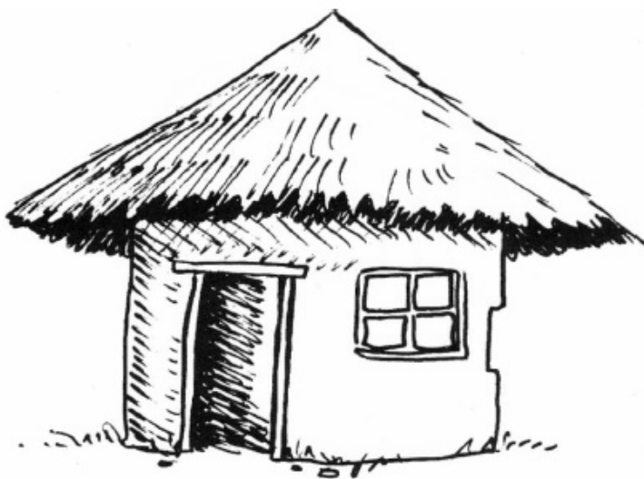
Acoperișul conic din paie este foarte obișnuit la casele africane din cob.
